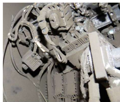
Årsagen til kortslutningen er fejlkobling af kontakter for ekstern forsyning.
